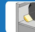
La laine est utilisée en bordure de toits ou de relevés pour adoucir l'angle de rencontre entre le plan horizontal et vertical des parapets ou de tout relevés. Offerte en version naturel ou ignifuge.
